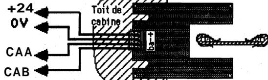
**Le +24 et le 0V du connecteur KC22 ne doivent être utilisés que pour l'alimentation du capteur uniquement !**
