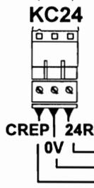
Figure 36 Connexion du répéteur de position en cabine modèle ID 50 2 DIGITS
