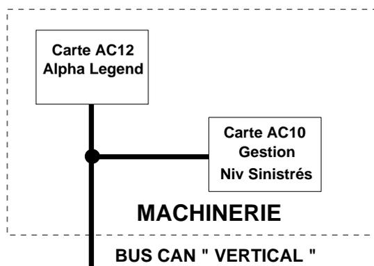
Dans le cas de **plusieurs Appareils**, une **seule Carte AC10** est connectée sur le **Bus Horizontal** reliant les différents Appareils. On rappelle que dans ce cas, les Armoires doivent être équipées de cartes **AC13** pour générer le Bus Horizontal.
