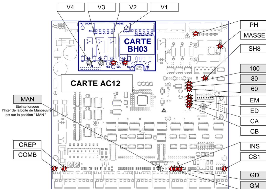
Appuyer sur le bouton poussoir « **Descente** » et vérifier que la LED « **GD** » s'allume sur la carte AC12 ainsi que sur la carte hydraulique BH03 du contrôleur.
