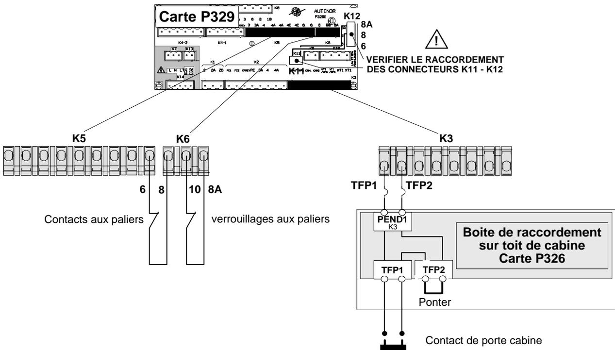
(\*) La norme EN 81 (§ 7.7.4.2) autorise l'utilisation d'un contact de porte palière unique dans le cas d'un entraînement mécanique simultané des portes palières et de cabine.
