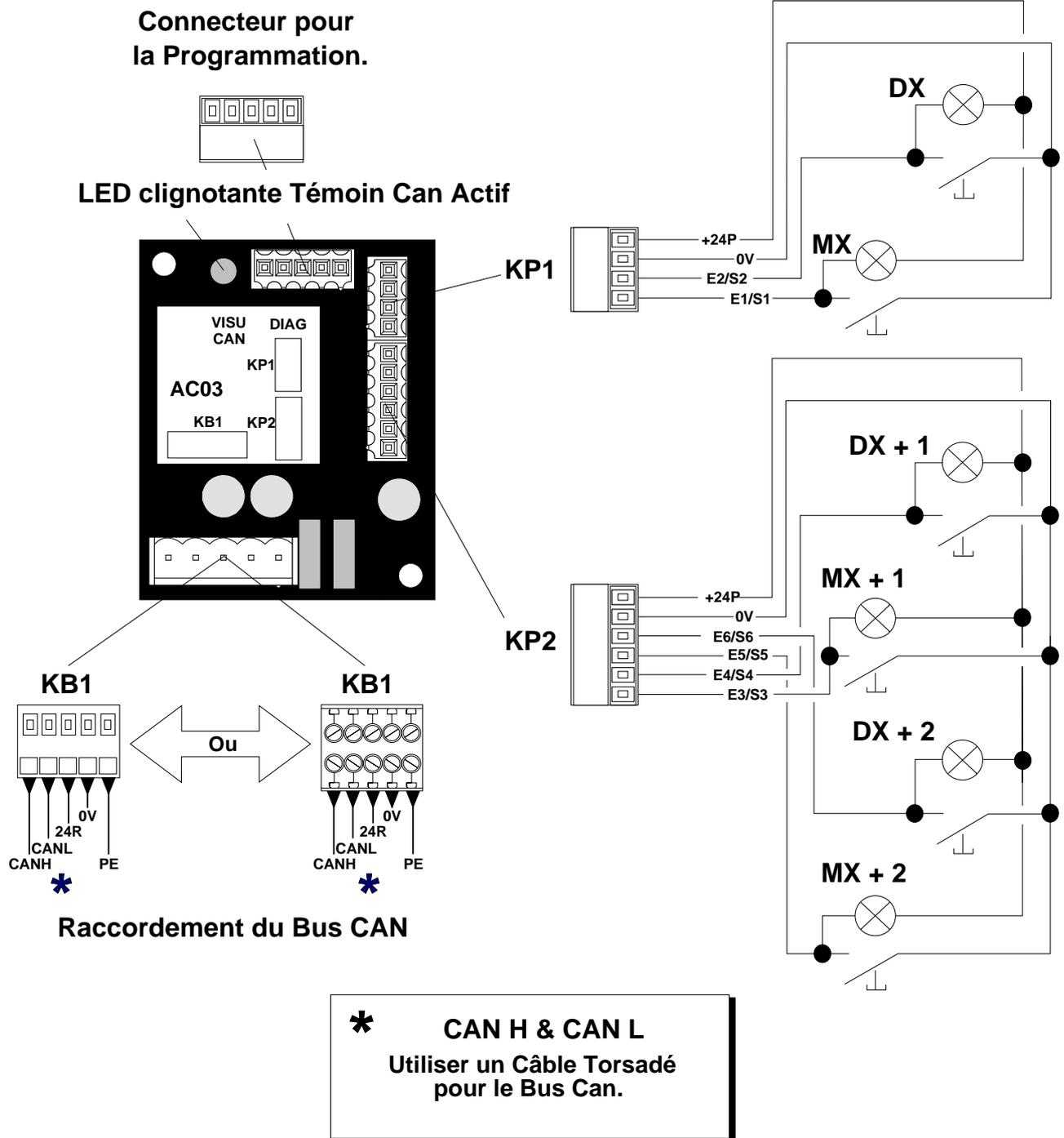
**REMARQUE :** En cas de **précablage** fourni par Autinor, une Interface « Répartiteur » facilite le raccordement des boîtes palières sur les cartes AC03.
