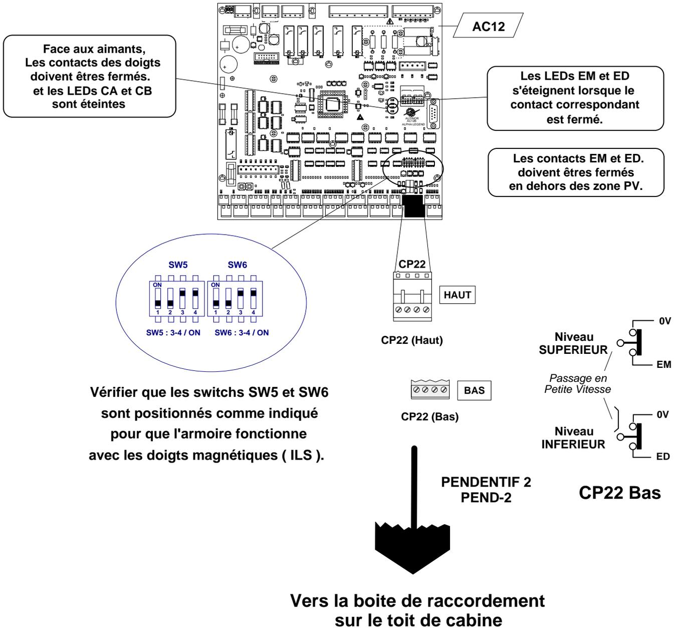
Vérifier que les switchs SW5 et SW6 sont positionnés comme indiqué pour que l'armoire fonctionne avec les doigts magnétiques ( ILS ).
