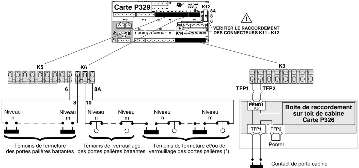
(\*) La norme EN 81 (§ 7.7.4.2) autorise l'utilisation d'un contact de porte palière unique dans le cas d'un entraînement mécanique simultané des portes palières et de cabine.
