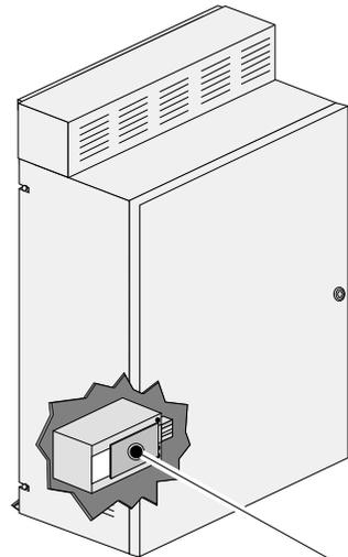
En l'absence de manoeuvre de rappel, pontage des bornes 2A et 3 du connecteur K8
