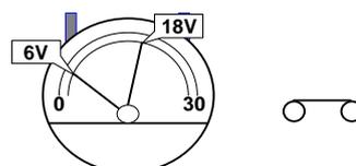
Le contact ED est fermé quand la tension mesurée entre le " - " et le " b ", en continu, est égale à 6 ou 18 volts.
