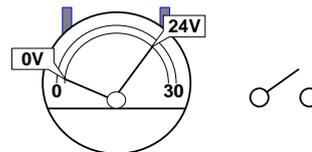
Le contact ED est ouvert quand la tension mesurée entre le " - " et le " b ", en continu, est égale à 0 ou 24 volts.
