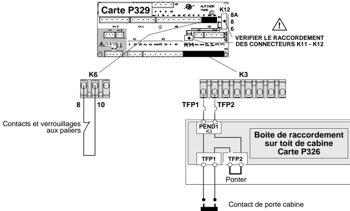
(\*) La norme EN 81 (§ 7.7.4.2) autorise l'utilisation d'un contact de porte palière unique dans le cas d'un entraînement mécanique simultané des portes palières et de cabine.
