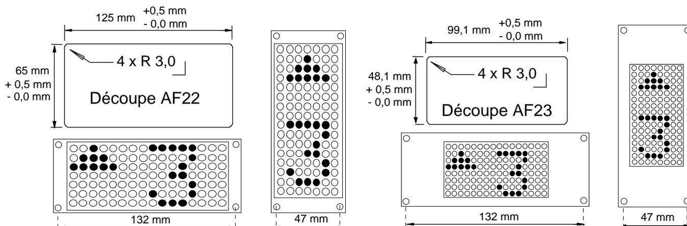
Afficheur **AF23**, 16 x 8 points lumineux, dim. efficace 37 x 76 mm, dim ext : 55 x 140 mm.
