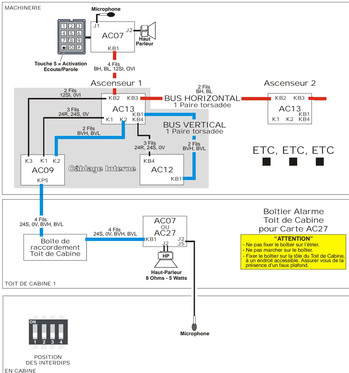
La carte **AC27** (ou AC07) en **Machinerie** équipée d'un **Haut-parleur**, d'un **microphone** est en plus munie d'un **Clavier d'orientation** permettant de sélectionner la cabine avec laquelle on souhaite établir une communication.
