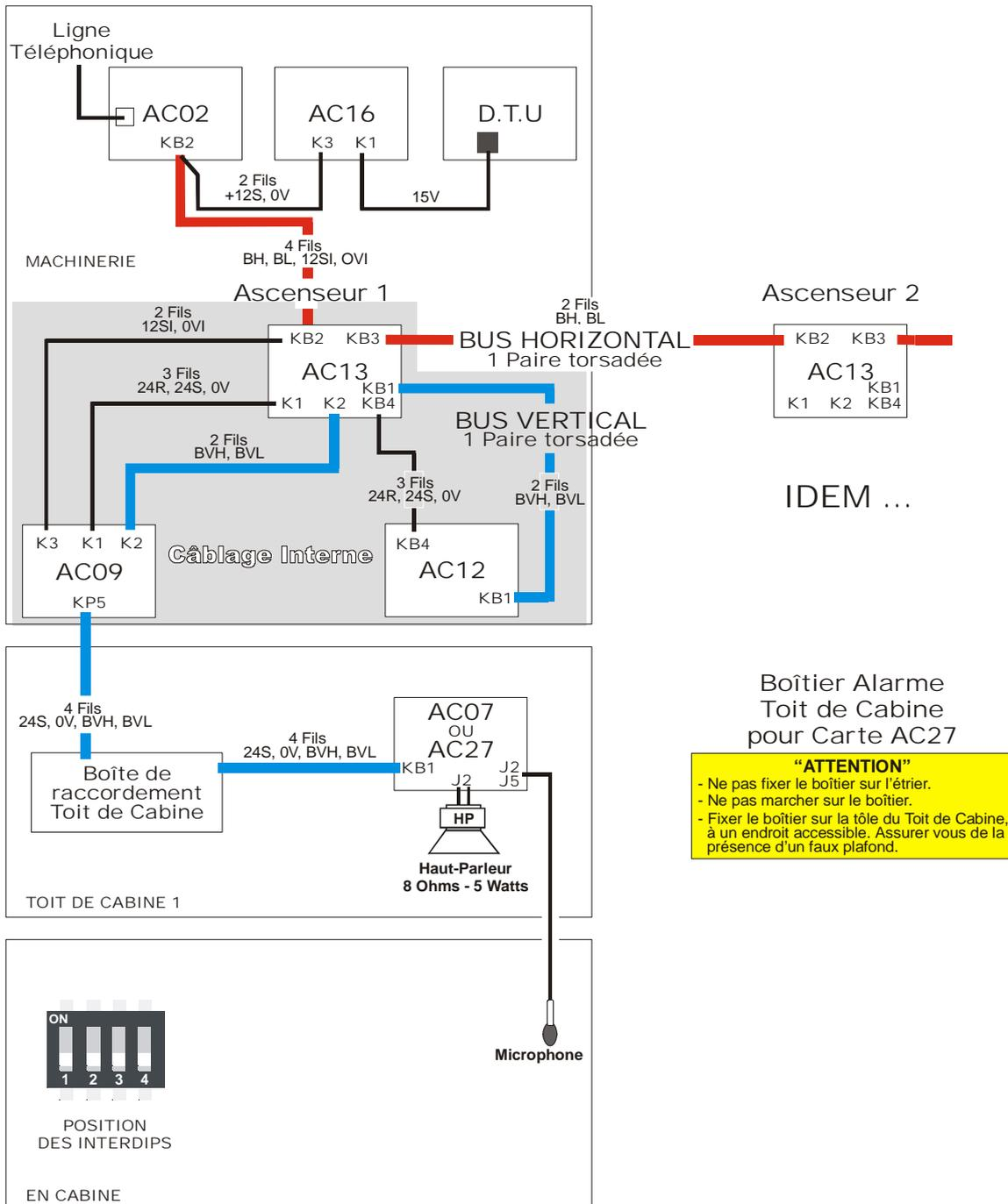
La carte **AC02** Interface Bus Can / Modem sera raccordée sur le **Bus Can « Horizontal »** qui relie les armoires déjà en cas de Multiplex ou & et dans le cas de niveaux sinistrés.
