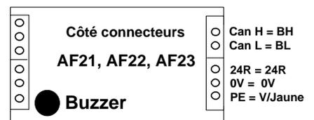
La carte AC05 doit être fixée avec une entretoise métallique pour être mise à la terre.
