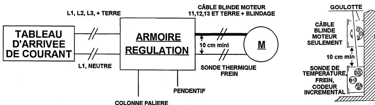
**On vérifiera que le câble se raccordant au tableau d'arrivée de courant ne circule pas à proximité de la liaison MLI VECTOR - MOTEUR.**
