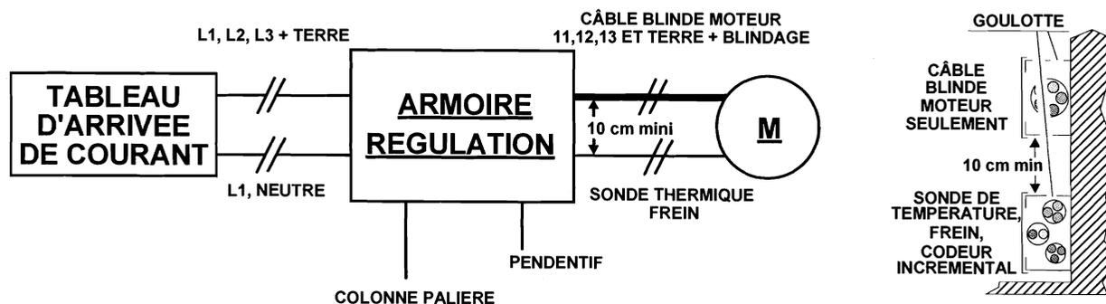
**On vérifiera que le câble se raccordant au tableau d'arrivée de courant ne circule pas à proximité de la liaison MLift PIM - MOTEUR.**
