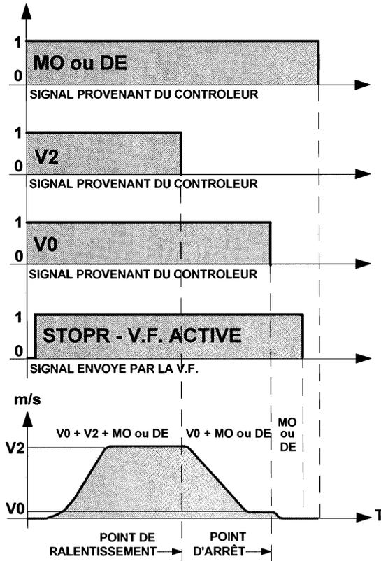
Le ralentissement se fera en perdant V2 tout en maintenant V0 et MO ou DE jusqu'au point d'arrêt.
