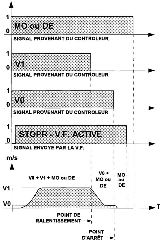
Le ralentissement se fera en perdant **V1** tout en maintenant **V0** et **MO** ou **DE** jusqu'au point d'arrêt.
