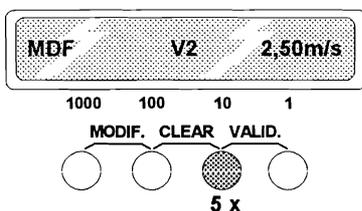
Mémorez la nouvelle vitesse dans le module en appuyant sur les boutons VALID simultanément
