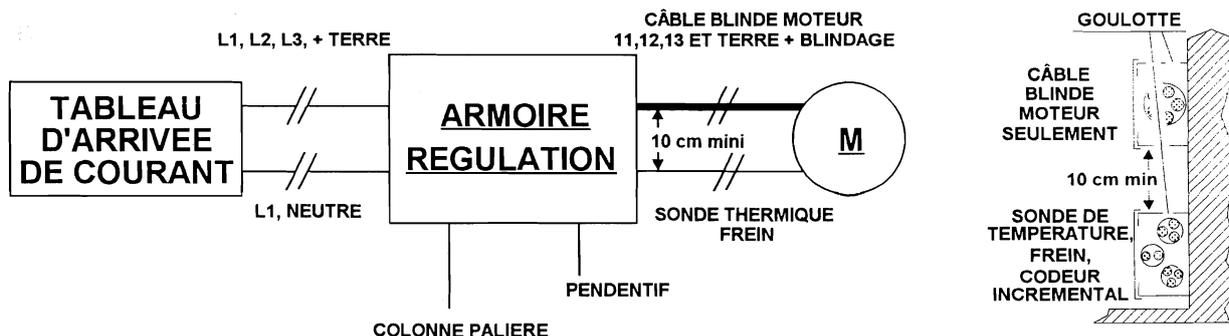
On vérifiera que le câble se raccordant au tableau d'arrivée de courant ne circule pas à proximité de la liaison VF3000 VECTOR - MOTEUR.
